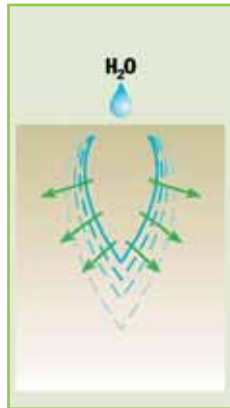
Fig. 1 Tipico profilo di diffusione dell'acqua in un substrato granuloso
