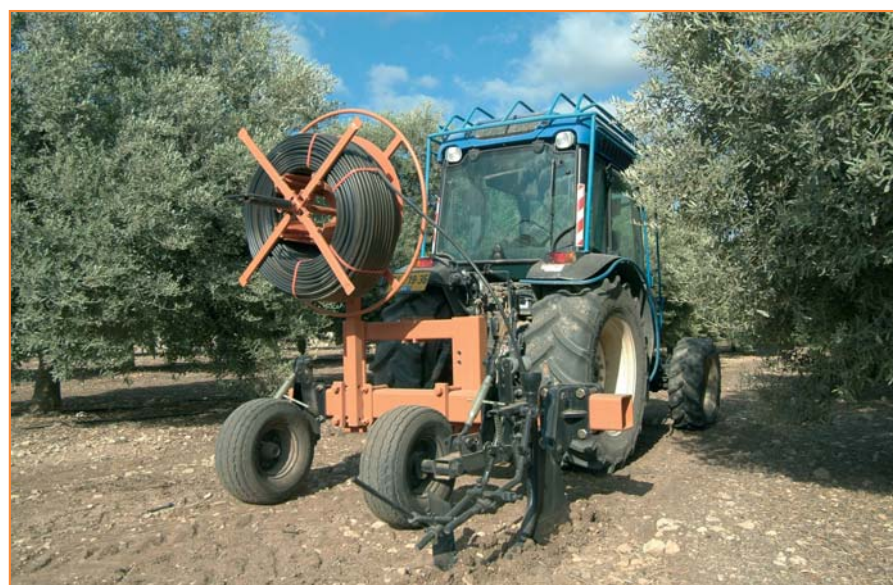
Macchina per la posa dell'ala in subirrigazione
